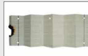
Der Original-Luftfilter hält der Beflammung gemäß DIN 53438 optimal stand.
